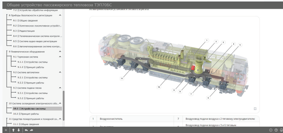
Устройство централизованной системы воздухообеспечения
